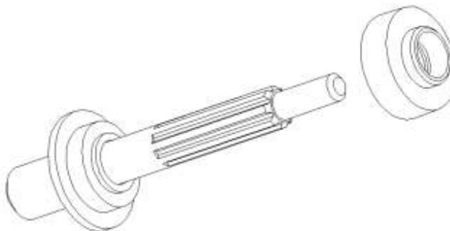
3. Смажьте поверхность ВТУЛКИ и установите ее в КОРПУС ВИНТА.
