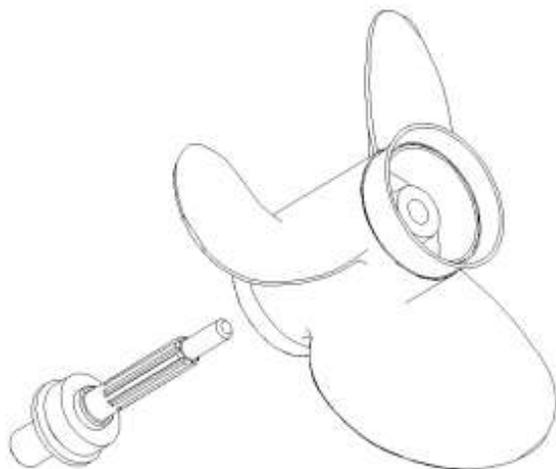
5. Установите оригинальную ПЛОСКУЮ ШАЙБУ на гребной вал мотора и затяните гайку как требует инструкция мотора.
