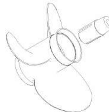
4. Установите ВИНТ В СБОРЕ на гребной вал мотора.
