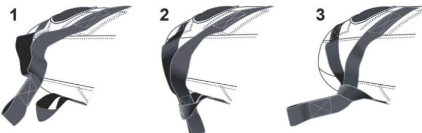
**ЗАМЕЧАНИЕ:** Данная система может быть использована только так, как показано на схеме выше. Иначе, если используется только одна из петель, повышается риск повреждения чехла или аттракциона. Повреждения полученные вследствие неправильной эксплуатации не покрываются гарантией.
