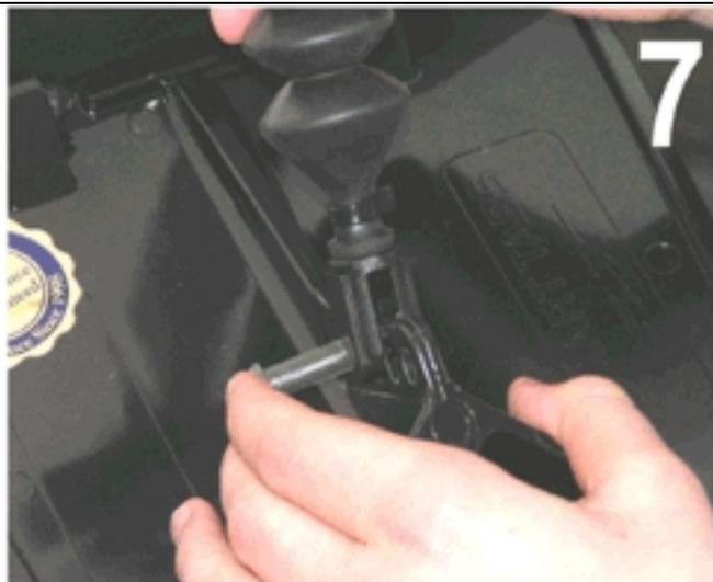
Присоедините привод: Используя «snap&lock» - штифты диаметром 5/16", присоедините нижнюю часть пневмопатрона к внешней стороне плиты через отверстие №3. Обратите внимание: при необходимости, силу давления можно изменить так, чтобы она подходила для вашей лодки, после проведения испытания на воде.
