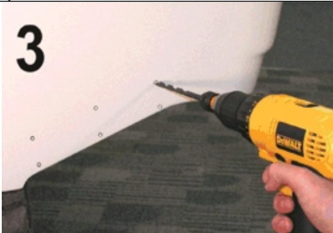
**Просверлите отверстия:** Используйте сверло 7/32" (5,5 мм) для транца из стекловолокна, и сверло 3/16" (4,8 мм) для транцев из алюминия и дерева.
