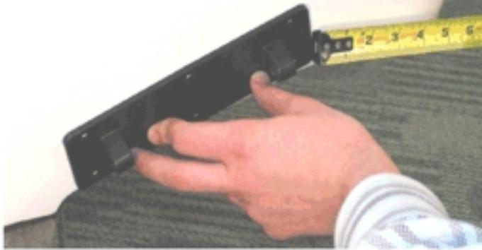
**Выберите место:** Рекомендуется устанавливать на расстоянии в 7-12 см от внешнего края транца. (При этом следует обратить внимание на то, чтобы при полном повороте мотора Работаящий винт не касался лопастями плит.) Выровняйте нижний край петли по нижнему краю транца.
