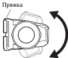
Совместить метку на боковой крышке с риской на корпусе и повернуть защелку по часовой стрелке до щелчка. Пряжка поворачивается относительно корпуса на 170° с промежуточной фиксацией.
