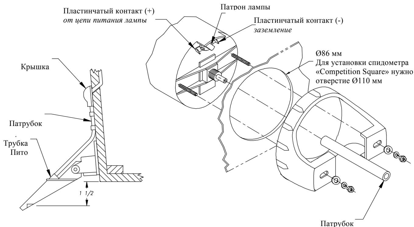
**ПРЕДУПРЕЖДЕНИЕ:** На время установки отключить аккумулятор. Все стяжные гайки подтянуть пальцами (усилия 0,65 Н·м будет достаточно). Излишнее усилие крепления может повредить прибор, что не покрывается гарантией.
