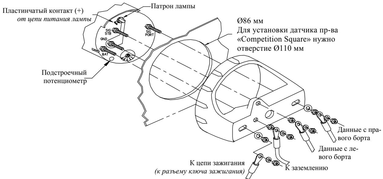
Синхронизатор компании «Faria® Marine» для пары моторов создан для высокоточного сопоставления скоростей двух моторов. На холостых оборотах синхронизация моторов затруднительна. Для правильной работы синхронизатора оба мотора должны быть одного типа, с одинаковым количеством цилиндров, с одинаковым зажиганием. Неработающая система зажигания или прыжки по волнам на высокой скорости – не позволяют выполнить синхронизацию.
