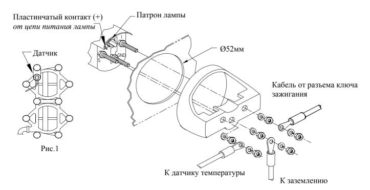
**ПРЕДУПРЕЖДЕНИЕ:** Этот прибор настроен только для работы с датчиками  $Faria^{\circledast}$  для измерения температуры головки блока цилиндров.
