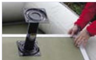
**Стойка для кресла** (18 см или 33 см) представляет собой простую и надежную конструкцию для установки кресла на элемент составного пайола.
