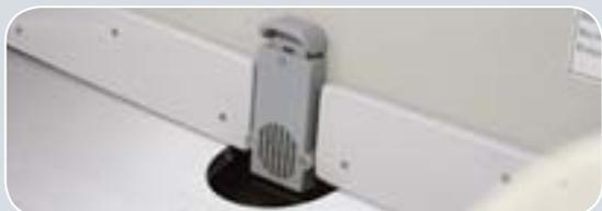
**Сливной клапан** установлен в нижней части транца и предназначен для слива попавшей в кокпит воды. Управление клапаном осуществляется изнутри лодки с помощью запорного устройства с мембраной. Слив воды возможен как на стоянке, так и во время движения.
