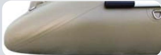
Продольную остойчивость такого небольшого по длине корпуса эффективно обеспечивают специально разработанные для лодок этой серии **плоские концевики баллонов**, имеющие большую площадь контакта с поверхностью воды.
