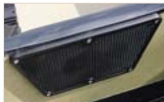
**Накладка на транец** из пластика. Защищает поверхность транца от элементов крепления лодочного мотора. Цвет: серый или черный. Код DJ1301
