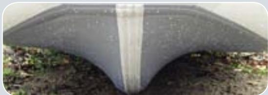
**Увеличенная килеватость** корпуса, полученная за счет использования 2-секционного надувного киля Twin Keel, обеспечивает максимально эффективное прохождение судном короткой волны и, делает движение в сложных погодных условиях максимально комфортным.
