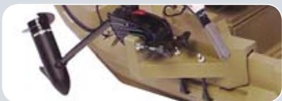
На борт моделей серии Stealth можно установить **съёмный транец**, предназначенный для электромотора или бензинового подвесного двигателя мощностью до 2 л. с. Боковое расположение мотора удобно при движении по мелководью.
