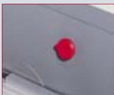
**Стравливающий клапан** установлен в носовом баллоне и при критическом увеличении давления более 300 mbar (в результате удара или сильного нагрева на солнце) автоматически стравливает воздух до величины 250 mbar. Эллиптические перегородки между баллонами при этом уравнивают давление в кормовых баллонах.
