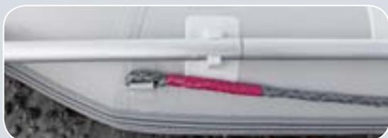
Небольшие размеры лодок предъявляют особые требования к установке весел, которые всегда выступают за габариты корпуса. Поэтому на судах этой серии предусмотрена возможность **фиксации каждого из весел** в одном из двух возможных положений.
