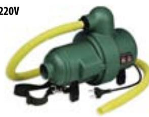
Насос **Bravo 2000** может использовать один или два нагнетателя и выдавать производительность до 2500 л/мин. Давление в баллонах может достигать 500 мBar. При работе двух двигателей потребляет 2000 Ватт. Код 6130206
