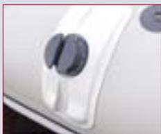
**Съемный якорный рым** предназначен для быстрой постановки и снятия судна с якоря. Имеет V-образный замок, автоматически фиксирующий якорный фал диаметром 6–10 мм при натяжении. Для снятия с якоря достаточно подтянуть веревку на себя и она немедленно высвободится из замка.
