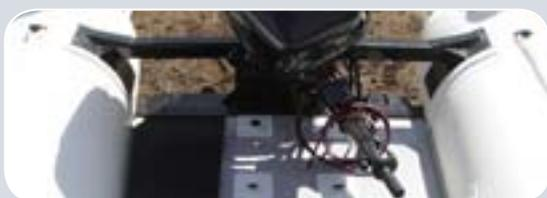
**Транец из алюминиевого сплава** позволяет устанавливать на спортивную модель FC410 двигатель мощностью до 50 л. с. и имеет отверстия для прямого слива попавшей в кокпит воды, что вполне возможно, так как палуба судна находится выше поверхности воды.
