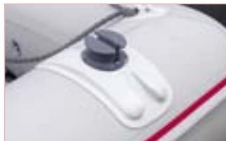
**Якорный рым** снабжен замком из пластика с V-образным профилем, который позволяет быстро зафиксировать якорную веревку диаметром 6–8 мм.
