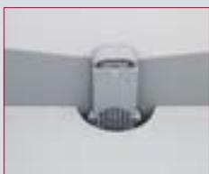
**Створчатый клапан** предназначен для слива попавшей в кокпит воды. Он позволяет во время движения судна практически полностью удалить попавшую внутрь корпуса судна воду за счет инерционных сил. Управление клапаном осуществляется из кокпита лодки с помощью запорного устройства с мембраной.
