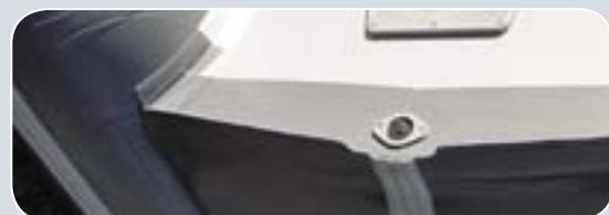
Нижние части кормовых баллонов, как и килевая линия судна, оснащены **специальными накладками** из толстой профилированной PVC ленты, которые защищают выступающие части баллонов и днища от протирания или повреждения.
