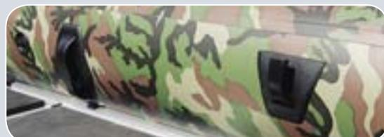
Для безопасного размещения оружия предлагается простая система из двух фиксаторов, расположенных на правом борту лодки, один из которых является открытым, что позволяет охотнику «укладывать» ружье в один прием.
