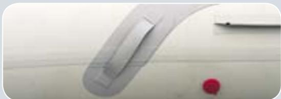
**Стравливающий клапан** при увеличении давления более 300 mbar (от удара или при нагреве на солнце) автоматически стравливает воздух до 250 mbar. Эллиптические перегородки между отсеками (камерами) при этом уравнивают давление в кормовых баллонах.
