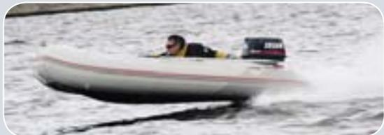
**Наклоненные вниз концевики** баллонов имеют в плоскости контакта с поверхностью воды отрицательный угол атаки, что позволяет поддерживать оптимальный ходовой дифферент, а также делает поведение лодки прогнозируемым и легко контролируемым.
