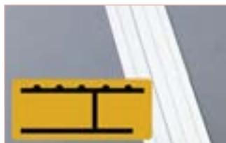
**Профиль Н-типа** (2,8 м) служит элементом («мама») замка для соединения щитов пайола между собой, а также для их защиты от повреждения. Код: Н-пр
