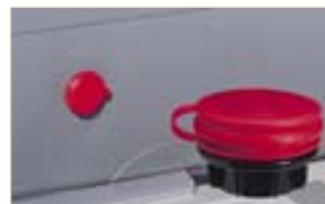
**Стравливающий клапан** при увеличении давления более 200 mbar (240 mbar) автоматически стравливает воздух до 150 mbar (185 mbar). Код 280A080005 (280A080007)
