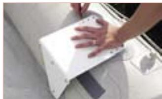
**Система UniMount** устанавливается на борт лодки и служит для монтажа оборудования, такого как даунриггер, эхолот и др. Цвет: серый, черный. Код UniMount
