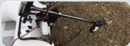
В кормовой части судна расположены **четыре держателя съемного транца**, на который может быть установлен электрический или бензиновый мотор мощностью до 3,5 л. с. Транец не входит в базовую комплектацию лодки и приобретается дополнительно.
