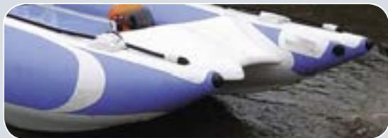
**Носовое пластиковое крыло** обладает реальными аэродинамическими качествами, в результате чего в ходе движения возникает дополнительная подъемная сила, благодаря которой туннельный корпус и обладает столь высокими ходовыми характеристиками.
