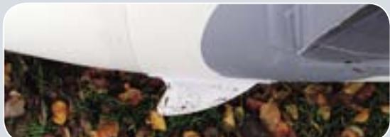
**Курсовые стабилизаторы** (плавники), установленные в кормовой части надувных баллонов, обеспечивают судну точное следование курсу, прохождение быстрых поворотов с минимальным сносом, а также защиту нижней части баллонов при вытаскивании лодки на берег.
