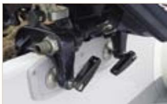
**Накладка на транец** из металла для установки на транец и защиты его поверхности при контакте со струбцинами. Цвет: серый или черный. Код DJ1202
