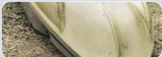
**Низкопрофильное днище** на большинстве моделей охотничьих лодок имеет катамаранные обводы, что дает возможность свести к минимуму осадку судна и обеспечить при этом его максимальную остойчивость.
