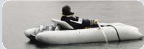
Для защиты ног от волн и брызг лодка оборудована **носовым чехлом**, верхняя часть которого имеет ремни для регулировки, что позволяет рыболову или охотнику не только подогнать его размер под себя, но и, при необходимости, хранить в ногах часть снаряжения.
