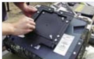
**Переходник** представляет собой разъем из прочного пластика, который позволяет быстро установить кресло на стойку или на поворотную платформу.
