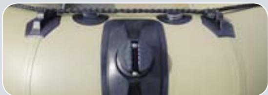
**Носовой якорный рым** снабжен замком, который позволяет быстро зафиксировать якорную веревку в необходимом положении. Для того, чтобы сняться с якоря, достаточно просто потянуть веревку на себя, и она немедленно высвободится из замка.
