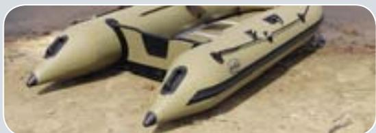
**Специальные накладки**, расположенные в нижней части надувных баллонов в кормовой части судна, защищают материал баллонов от протирания или повреждения при движении лодки по мелководью или во время ее вытаскивания на берег.
