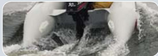
**Комингсы (косынки)**, изготовленные из PVC, установлены в местах стыковки транца и надувных баллонов и предназначены для дополнительной защиты кокпита от попутной волны, а также от попадания брызг в ходе движения или маневрирования судна.
