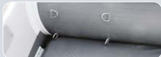
Левый борт кокпита судна в кормовой части оснащен **4-х точечным креплением** для топливного бака или других элементов снаряжения. В носовой части корпуса также находятся два кольца для фиксации гермомешка, сумки под якорь или иных аксессуаров.
