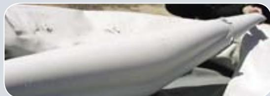
**V-образная форма днища**, особенно выраженная в носовой части корпуса, получена за счет надувного киля Twin Keel, в сечении образующего несимметричную восьмерку, который обеспечивает лодкам максимально мягкое и эффективное прохождение волны.
