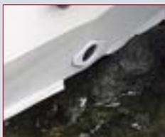
**Кормовой интерцептор** выполнен из многослойного PVC и расположен на нижнем торце транца лодки. Он способствует ровному сходу потока воды и существенному снижению брызгообразования за кормой, а также является дополнительной защитой нижней части транца при движении по мелководью.
