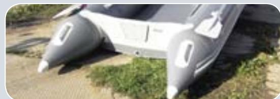
Исходя из требований компактности, на все лодки устанавливается транец из водостойкой фанеры толщиной 25 мм, рассчитанный на установку двигателя **мощностью до 15 л. с.** С целью дополнительной защиты поверхность транца ламинирована пластиком.
