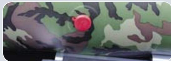
Для изготовления лодок используется PVC материал с плотностью **1300 гр./м<sup>2</sup>** и толщиной 1,1 мм, прочность которого выше аналогов на 30–40%. Слой камуфляжной раскраски толщиной 0,4 мм, в отличие от большинства окрашенных аналогов, «внедрен» в PVC методом экструзии.
