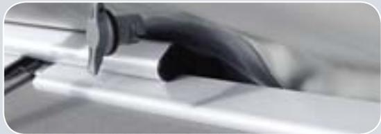
**Специальные накладки** защищают материал баллонов от истирания в местах контакта со стрингерами. Все щиты пайола, изготовленные из ламинированной фанеры, за исключением носового элемента, по периметру армированы алюминиевым профилем.
