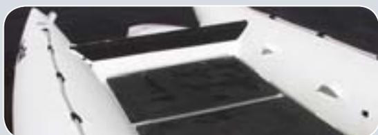
**Фанерный составной пайол** катамарана устанавливается в гибкие замковые крепления и покрыт мягким нескользящим полиуретановым составом, который обеспечивает комфорт и защиту от травм пилотам этого спортивного болида.
