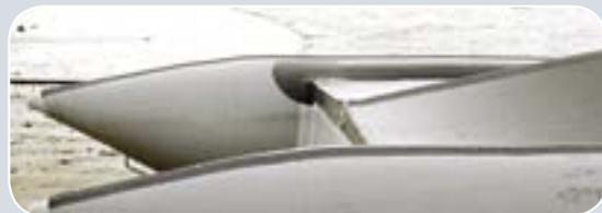
**Для защиты** нижней части кормовых баллонов и нижней поверхности днища, образованной надувным килем Twin Keel от истирания при вытаскивании лодки на берег или повреждения при движении по мелководью, эти места усилены профилированными накладками.
