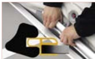
**Замок «стрингер»** предназначен для фиксации щитового пайола и на концах защищен пластиковыми заглушками. Типоразмер зависит от длины лодки.
