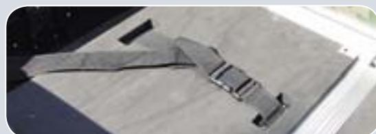
Пайолы из водостойкой фанеры с наружной стороны имеют мягкое покрытие, которое гасит звук и вибрации при перемещениях внутри лодки. Оба сидения также оклеены мягким покрытием, что позволяет сделать процесс охоты в засидке более комфортным.
