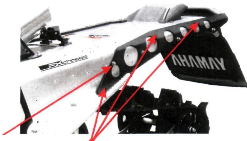
Шайбы и гайки ставить наружу
