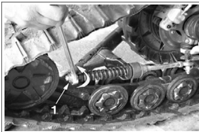
Рис. 3 Натяжная гайка пружины выравнивающей штанги
