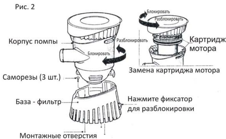
2. Используйте базу в качестве трафарета для разметки трех точек (под саморезы) крепления помпы.
