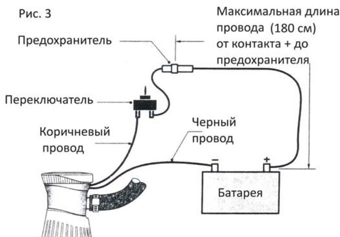
1. Подключите коричневый провод к переключателю. Для автоматического управления помпой используйте Автоматический плавающий переключатель Attwood #4201 или 4202. Подключите черный провод к контакту – аккумуляторной батареи.
