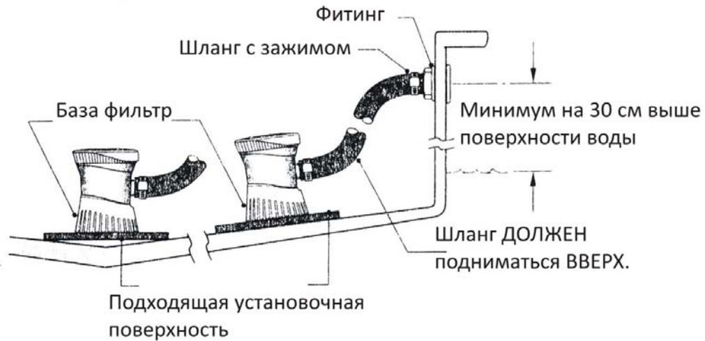
2. Не устанавливайте помпу прямо на корпус судна, установите помпу на установочную подходящую поверхность (фанера подходящего размера), затем приклейте ее к корпусу лодки.
