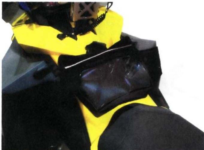
Место крепления «липучки» на бензобак протереть техническим спиртом. Для надёжного склеивания выдержать 12 часов при температуре не ниже 13°C.
