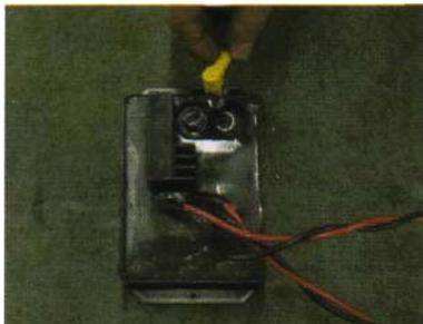
3. Подсоединить плоский кольцевой контакт красного провода от блока управления к плюсу аккумулятора. Надежно затянуть.
