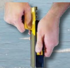
**Устройство для заточки Jiffy Blade Sharpener** - этот инструмент для правки плоских лезвий Jiffy представляет собой сборку из двух мелкозернистых поверхностей с алмазной крошкой, которые формируют заводской угол заточки. Устройство реализовано таким образом, что доводку затупившихся ножей можно проводить прямо на рыбалке.
