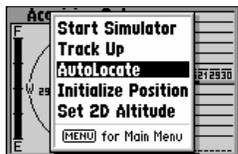
функция 'AutoLocate' запускает процедуру автоинициализации навигатора, когда навигатор пытается принять сигналы от всех доступных спутников до тех пор, пока сигналов станет достаточно для определения координат.
