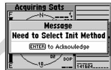
Если в течение 10 минут навигатор не смог определить своё положение в пространстве (или при первичном включении) на экране появится приглашение провести инициализацию. В этом случае требуется ввести в память навигатора данные о его приблизительном положении, чтобы тот мог определить, сигналы от каких спутников к нему поступают.
