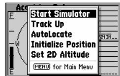
Для запуска режима Моделирования следует из страницы Состояния Спутников вызвать пункт меню Start Simulator.
