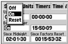
Таймер батареек автоматически обнуляется при смене батареек.
