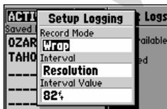
панель 'Setup Logging' позволяет выбрать метод записи пройденного пути и изменять его настройки.
