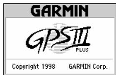
Экранная страница Приветствия появляется на экране навигатора GPS III+ после включения. Эта страница будет на экране всё время, пока навигатор выполняет самопроверку работоспособности.
