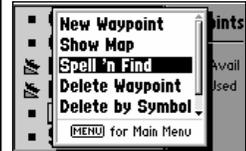
Функция «Угадай-ка» обеспечивает быстрый доступ к параметрам Точек, хранимых в памяти, для чего достаточно при помощи поворотной кнопки просто ввести имя желаемой Точки.
