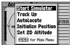
Меню настройки страницы Состояния Спутников позволяет включить режим моделирования, изменить ориентацию изображения небосвода на экране, а также инициализировать навигатор.
