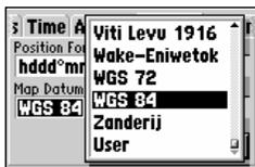
Более 100 систем счисления позволяют настроить показания навигатора согласно применяемой карте местности. Универсальной считается система счисления WGS 84.
