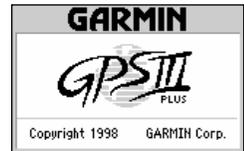
Экранная страница Приветствия появляется при самом первом включении навигатора GPS III+. После завершения короткой самопроверки правильности функционирования, примерно на 10 секунд на экране появится страница Предупреждения. Чтобы поскорее убрать с экрана страницу Предупреждения, следует нажать кнопку ENTER.
