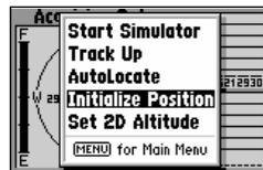
функция 'Initialize Position' используется для установления приблизительного положения прямо по карте, отображаемой на экране. Навигатор использует эти данные для того, чтобы сузить перечень спутников, связь с которыми он будет пытаться установить.
