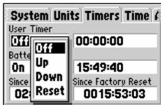
Функция 'User Timer' позволяет запускать таймер прямого и обратного отсчёта.
