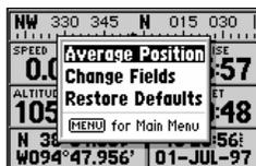
Экранная страница Настроек Координатной страницы позволяет усреднить координаты, полученные в течение некоторого времени и сохранить результат как Точку. Кроме того, можно изменить тип данных, отображаемых в экранном информационном поле Координатной страницы (поле 'Change Fields'), а также отменить все ручные настройки Координатной страницы (поле 'Restore Defaults').
