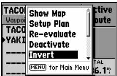
Чтобы назначить обратный порядок прохождения этапов маршрута, следует выбрать функцию 'Invert'.
