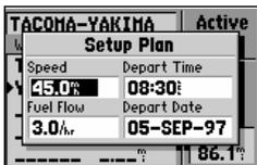
Функция 'Setup Plan' позволяет определить плановые скорость, расход топлива и время прибытия.
