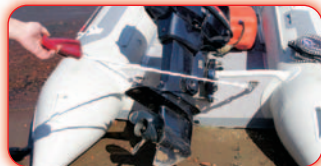
▲ сцепка для буксировки лыжника
