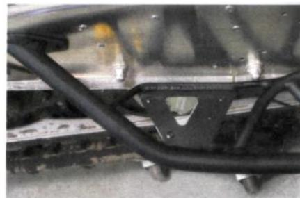
11. Высверлить отверстия  $\varnothing$  4,8 мм и установить клёпки в откидные подножки, как на рис. Ж.
