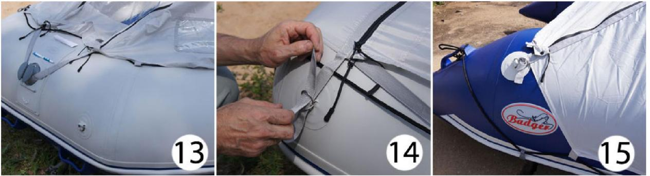
10. После того как тент будет закреплён в шести точках на бортах лодки, растяните край полотнища с помощью шнура и крючков, распределив их равномерно по борту. Возможно, придется перераспределить крючки для более равномерного натяжения края тента. (Рис.16).
