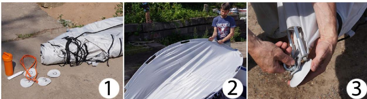
3. Отсоединить от узлов крепления дуг два пятка из ПВХ светло-серого цвета с резьбой в центре. (Рис.3).
