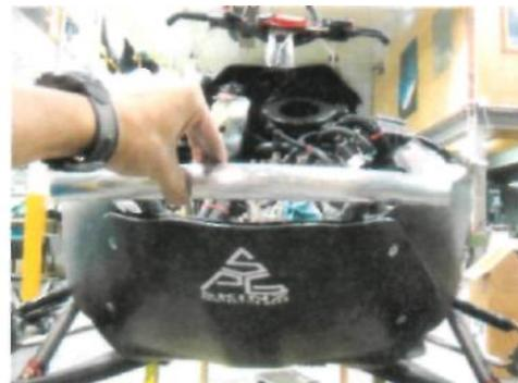
5. После установки капота можно укрепить алюминиевую перегородку, но можно ее и не ставить. Если решили отказаться от перегородки, ограничительные ремни капота нужно будет прикрепить к трубам жесткости бампера. Если перегородку будете ставить, останутся лишним два винта, которыми крепился прежний пластиковый бампер
