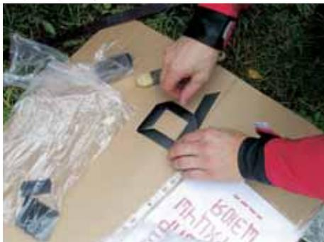
**Для установки номера на борт**, накачайте лодку, определите место нанесения номера, обезжирьте его поверхность растворителем №646. Приклейте заготовки в необходимой вам комбинации, для этого:
