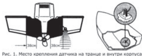
Рис. 1. Место крепления датчика на транце и внутри корпуса.
