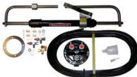
Данная гидравлическая система устанавливается на моторы мощностью от 20 до 250 л.с.
