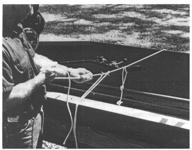
16. Пуская вперед лодку, всегда удерживайте при помощи шнура стопорения рукоять румпеля в нейтральном положении (вал винта горизонтален). Это же относится и к запуску мотора.
