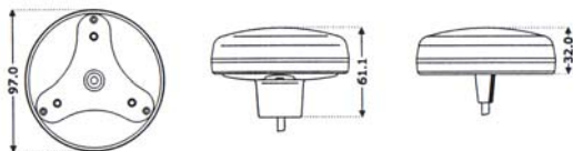
рис.5.5d Габариты антенны GPS
