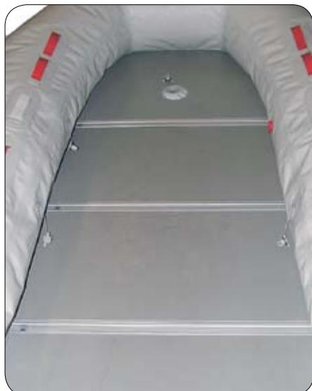
**9** Положите весло под днище лодки, чтобы приподнять настил с ровной поверхности.
