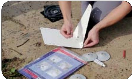
**2** На нем закрепите болтами монтажные пятаки. Определитесь с местом установки системы на борту лодки. Пятаки и поверхность лодки в месте установки должны быть сухими и чистыми. Обведите карандашом места прилегания монтажных пятаков к баллону, после чего отсоедините их от столика.
