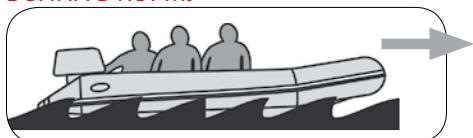
**!** Пассажиры не должны сидеть на баллонах лодки, так как, если человек упадет за борт, он может попасть под лодку или под винт мотора.
