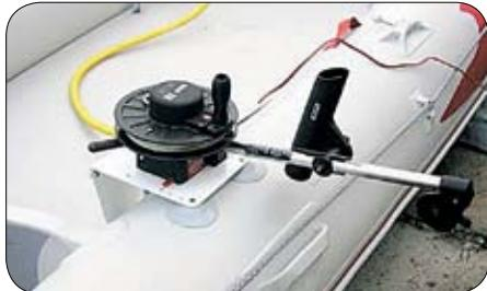
**1** В комплект входит сборный столик из 2-х элементов, три пятака с резьбой, клей для монтажа, крепежные болты. С помощью трех болтов с гайками, соберите столик.
