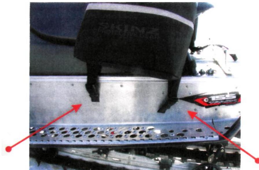
Выбрать на машине место для укрепления седельной сумки. С каждой стороны сумки имеются ремни крепления; нужно спустить их, как на фото.
