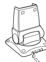
Рис.25: места выламываемых пазов для проводки кабелей
