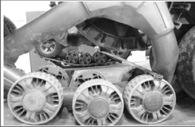
Рис. 19 Расстояние между задними пластиковыми колесами (опорными катками)
